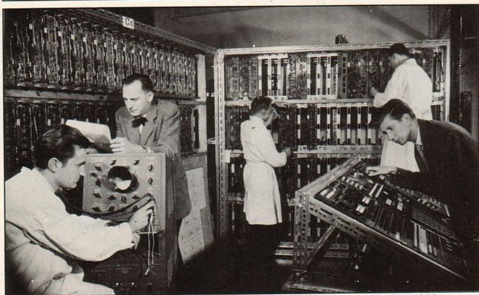
Ordinateur à calcul parallèle et mémoire à tambour construit en 1956 par l'Office national d'études et de recherches aérospatiales (ONERA).
