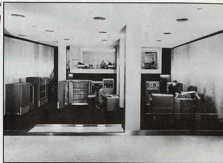
Lancé en 1952, l'ordinateur scientifique IBM 701 était doté de dérouleurs de bande magnétique et d'une mémoire centrale à tubes de Williams.
