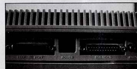
Impressionnante cette face arrière : sortie vidéo, connecteurs son mono et stéréo chaîne Hi-Fi, ports série et parallèle, prise pour second lecteur de disquettes et connecteur pour joystick aux normes... Atari. L'Amiga 500 propose aussi un bus pour extension mémoire.
