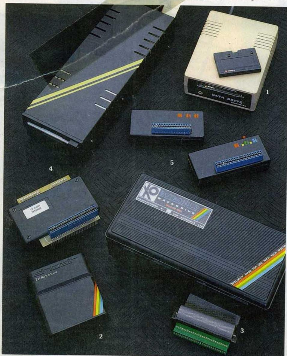
1-Le Quick data drive et sa micro-cassette pour C 64. 2-Le Microdrive Sinclair pour Spectrum. 3-Le Wafadrive Robotronics pour Spectrum. 4-Le lecteur de disquettes 3,5 pouces pour Spectrum et ZX81. 5-Le Mon « S » pour Spectrum.
